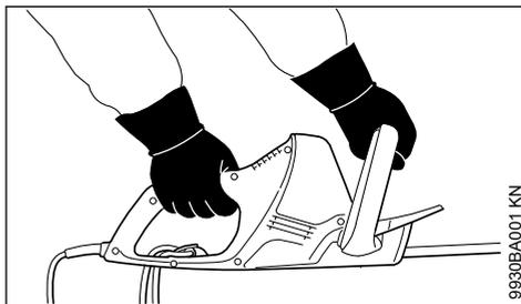
Main droite sur la poignée de commande et main gauche sur la poignée de la boucle.
